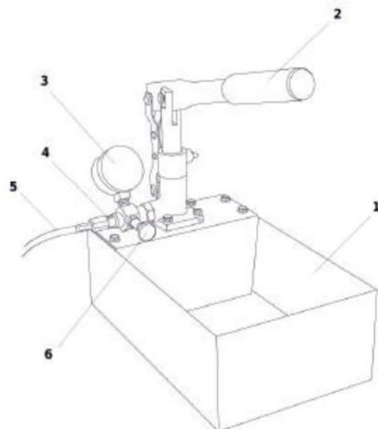
1-бак, 2-рукоятка, 3-манометр, 4-подсоединение шланга высокого давления 1/2 ", 5-шланг высокого давления, 6- вентиль V2.
