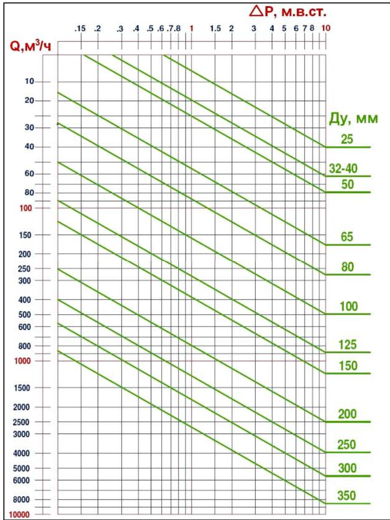
Рис. 2 Диаграмма зависимости потерь давления в затворе от расхода проходящей воды с температурой T=20^\circ\text{C} .
