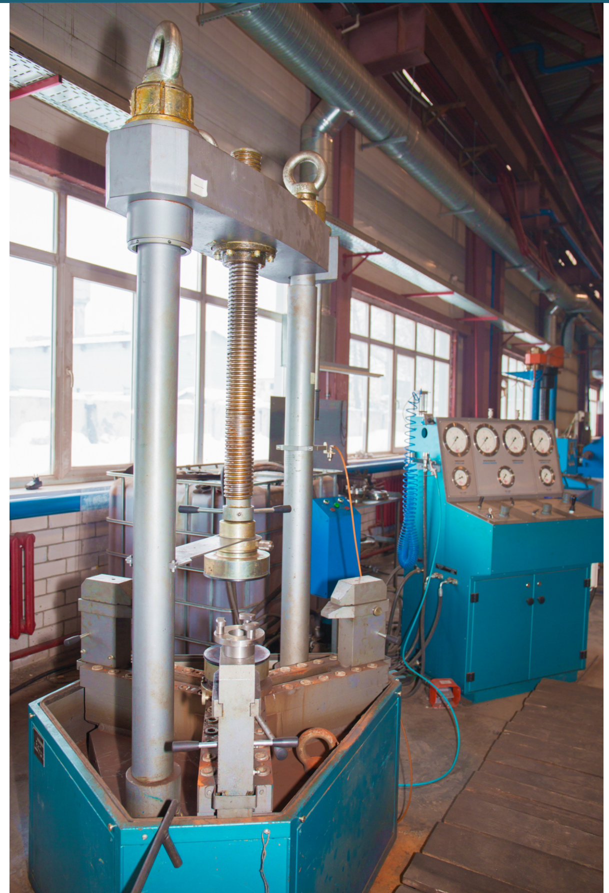
продукция 100% проверяется на сертифицированном опрессовочном стенде.
